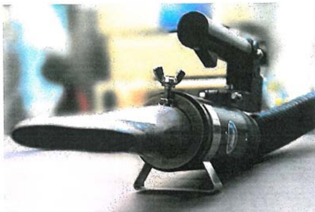
Ilustracja 2. Ręczne urządzenie do zgrzewania podczas drobnych prac wykończeniowych pap dachowych FIRE SMART™
