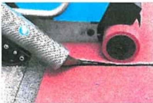
Ilustracja 3. Zgrzewarka automatyczna. Element grzejny w położeniu roboczym
